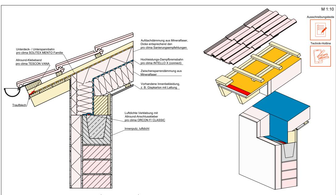
Dachsanierung von außen Steildach Traufe, flächige Verlegung, Mineralfaser Var.1
