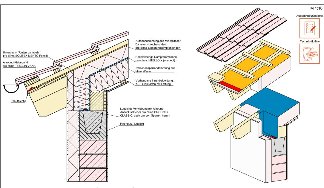
Dachsanierung von außen Steildach Traufe, flächige Verlegung, Mineralfaser Var.2 Sanierungsdampfbremse INTELLO X (connect) von außen flächig verlegt. Gefach- und Aufdachdämmung bestehen aus Mineralfaser.
